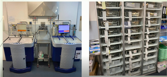
شکل ۲: سمت راست: قفسه استاندارد نگه داری اندوسکوپ، سمت چپ: دستگاه شست و شو
